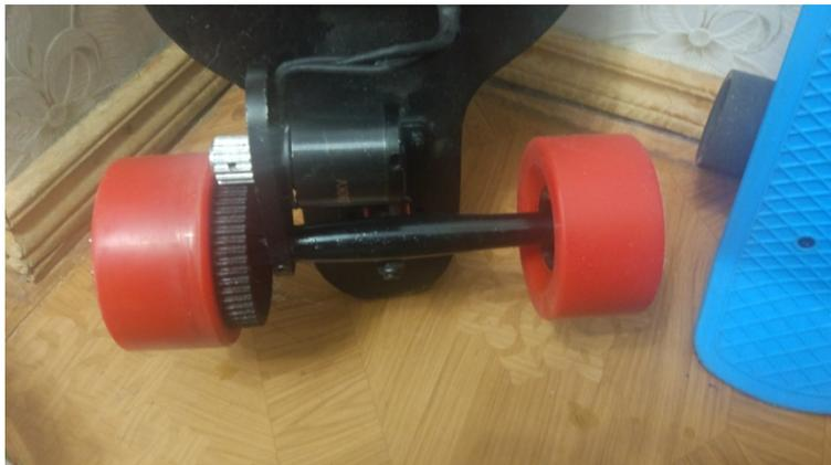
Рисунок 6. Установка двигателя и ведущей и ведомой шестерни
