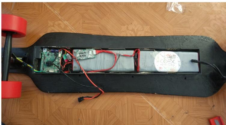
Рисунок 8. Устанавливаем электронику управления и аккумуляторы в защитный корпус
