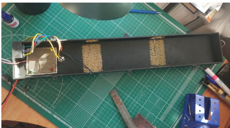
Рисунок 7. Сборка защитного корпуса для электроники
